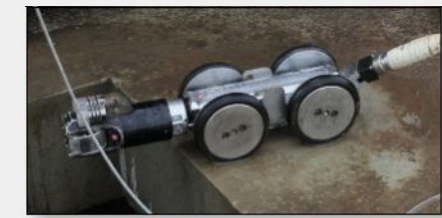
Televizní kamera pro kontrolu potrubí
